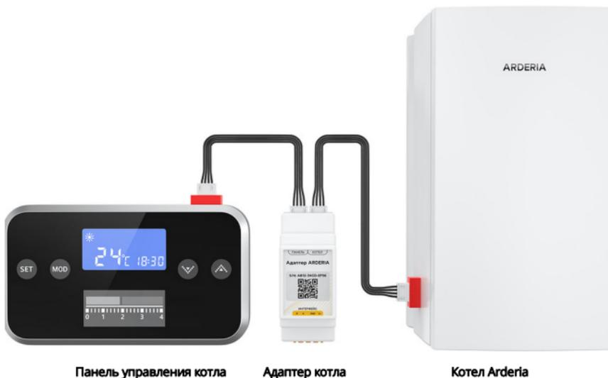
Если все подключения произведены успешно, система **ectoControl** и котел включены, индикатор адаптера будет гореть с короткими погасаниями: связь с системой и котлом успешно установлена.
